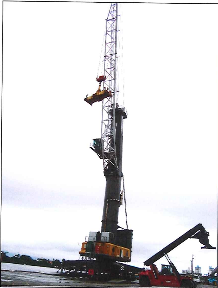
Figura 1. Guindaste de cais (Mobile Harbor Crane), MHC-02.
