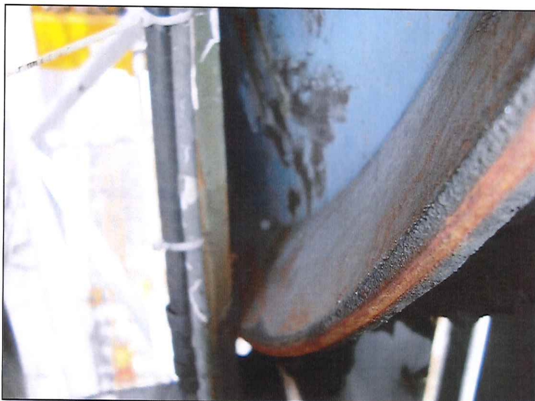
Figura 7. Detalhe do item de check-list #46; roldana frontal esquerda da torre com sinais de desgaste.
