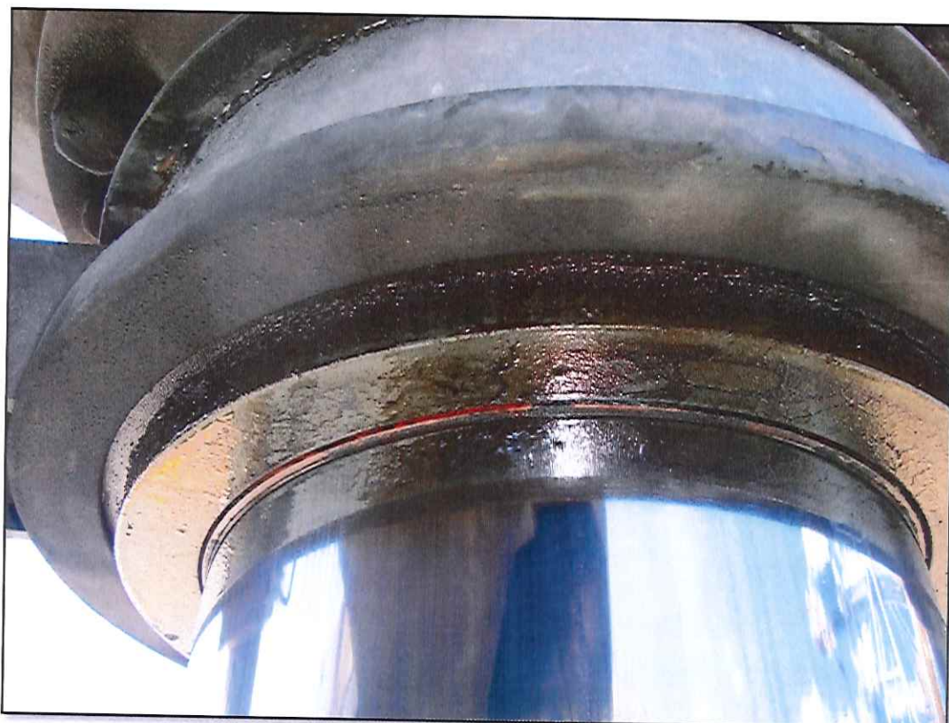
Figura 2. Detalhe do item de check-list #03; cilindro hidráulico da sapata #4 apresenta vazamento de óleo hidráulico.
