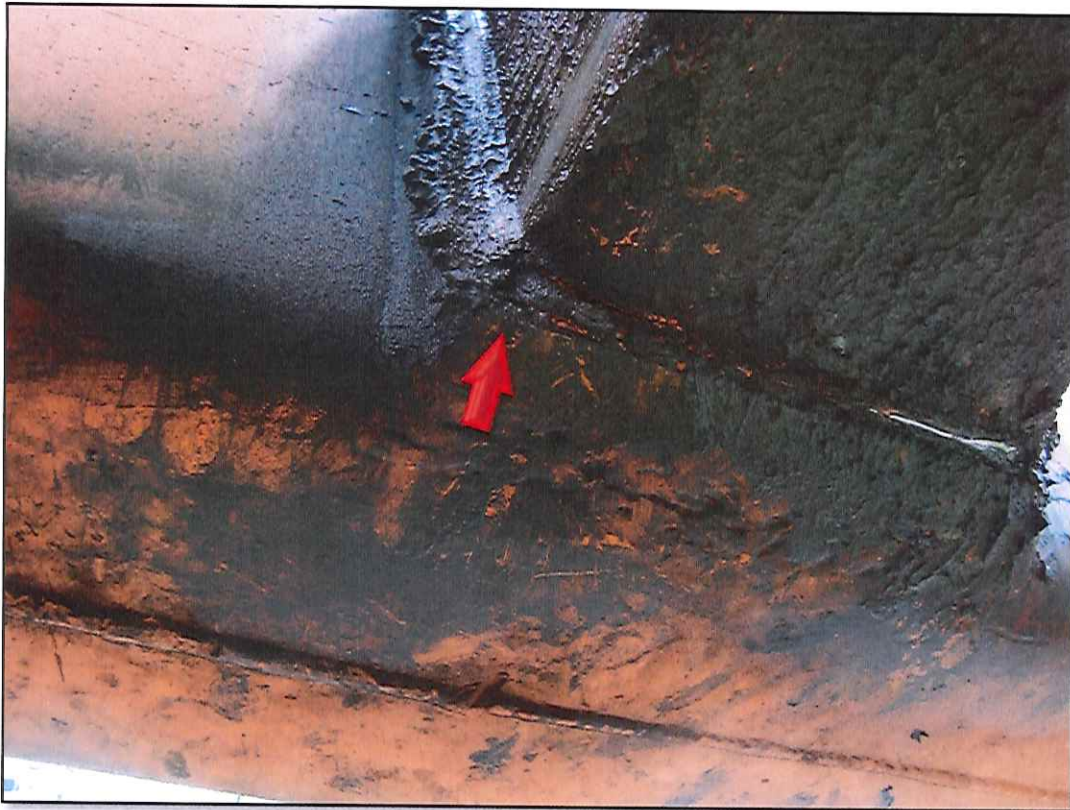
Figura 2. Detalhe do item de check-list #44; vazamento de óleo hidráulico nas mangueiras que sobem pela lança.
