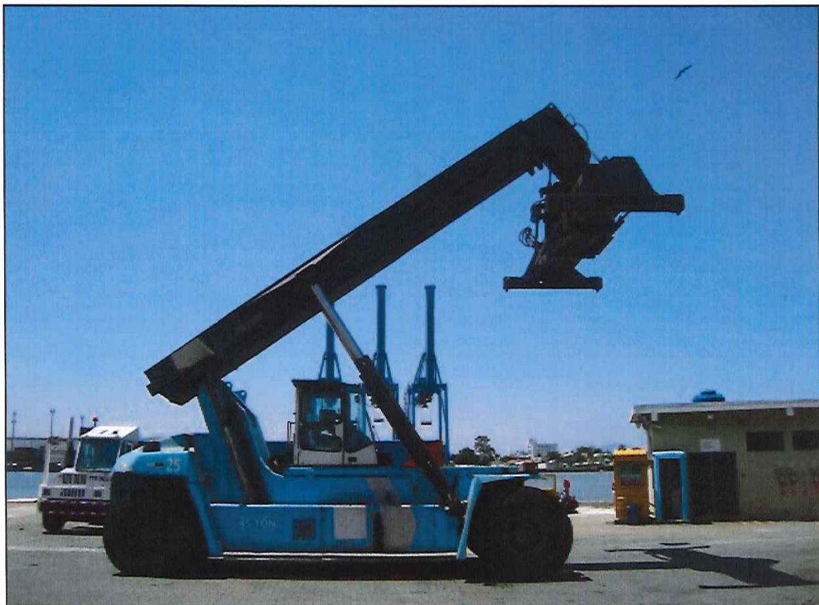
Figura 1. Empilhadeira de grande porte (Reach-Stacker), RSK-0025.
