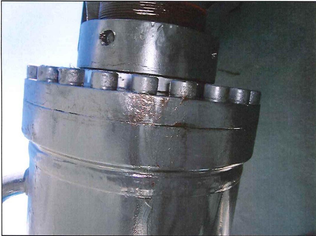
Figura 3. Detalhe do item de check-list #45; pequeno vazamento de óleo hidráulico no cilindro de elevação direito esquerdo.
