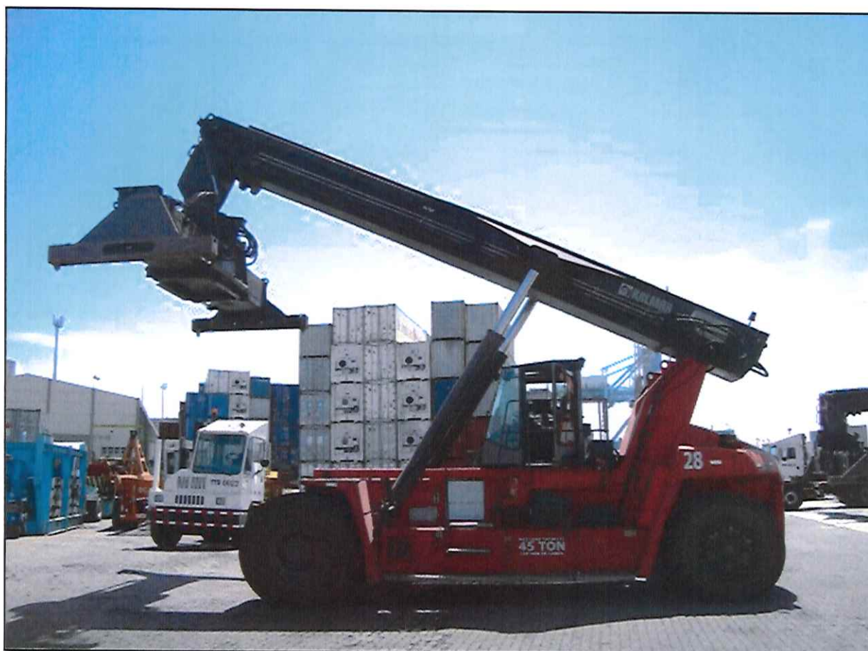
Figura 1. Empilhadeira de grande porte (Reach-Stacker), RSK-0028.
