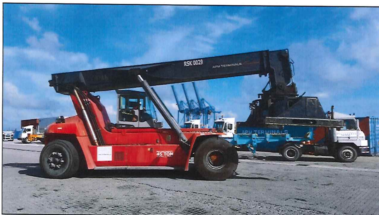
Figura 1. Empilhadeira de grande porte (Reach-Stacker), RSK-0029.
