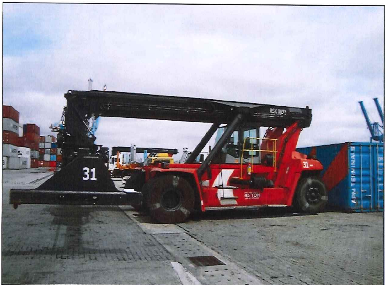
Figura 1. Empilhadeira de grande porte (Reach-Stacker), RSK-0031.
