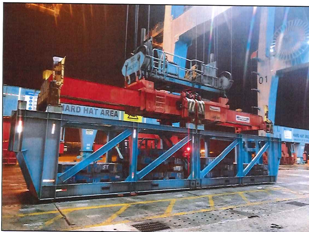
Figura 7. Teste de carga – Twin Lift.
