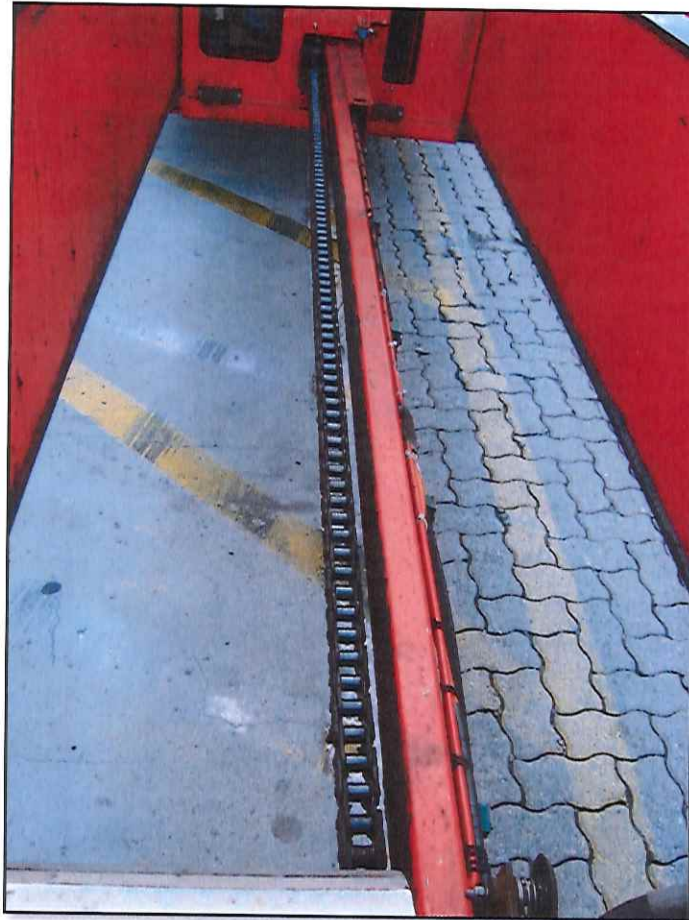
Figura 3. Detalhe do item de check-list #12; necessário ajustar corrente de abertura do spreader; necessário trocar as molas prato da corrente de abertura.
