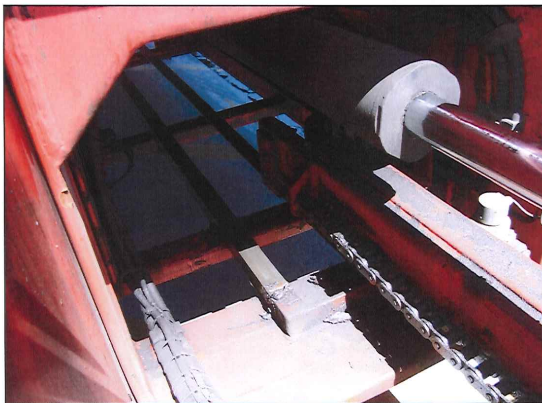
Figura 3. Detalhe do item de check-list #12; necessário substituir as molas prato da corrente de abertura do spreader.
