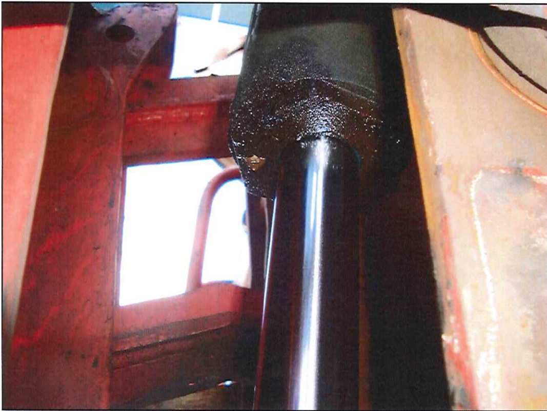
Figura 4. Detalhe do item de check-list #14; pequeno vazamento de óleo hidráulico no cilindro da caixa twin-lift esquerdo, lado terra.
