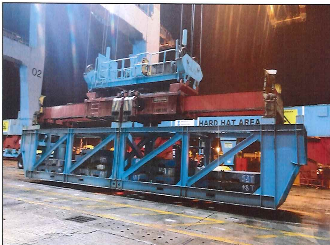
Figura 9. Teste de carga – Twin Lift.
