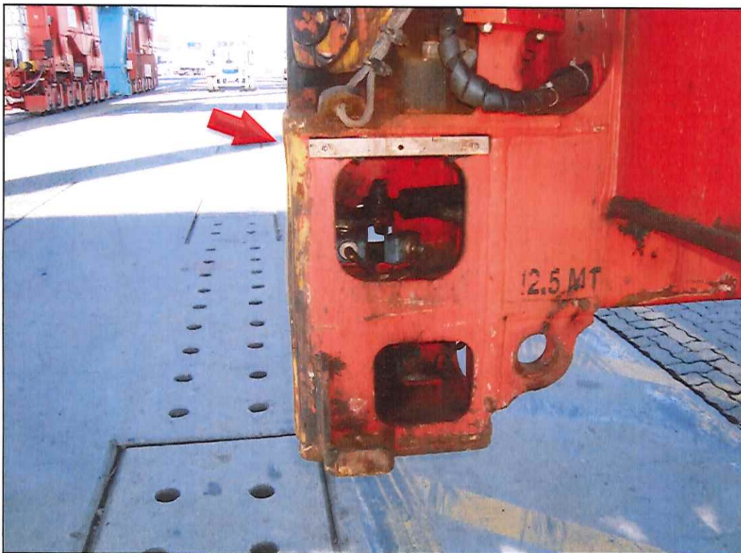
Figura 5. Detalhe do item de check-list #21; alojamento do twistlocks estão sem a manta de borracha para proteção.
