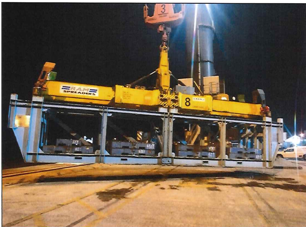
Figura 9. Teste de carga – Twin Lift.
