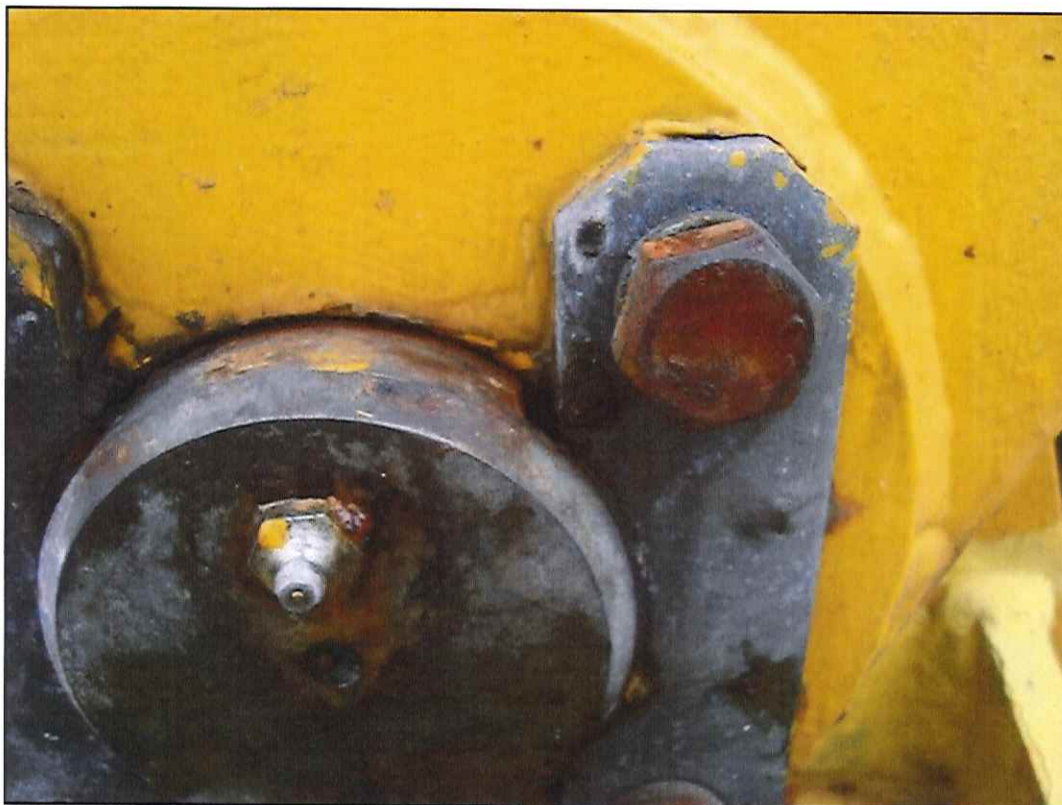
Figura 4. Detalhe do item de check-list #12; eixo do gravity point apresenta pequena folga.
