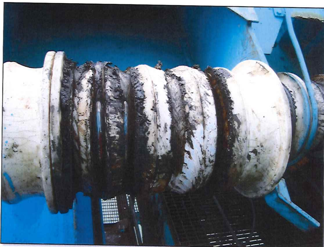
Figura 6. Detalhe do item de check-list #50; roletes de apoio dos cabos de aço localizados na emenda da lança estão desgastados.
