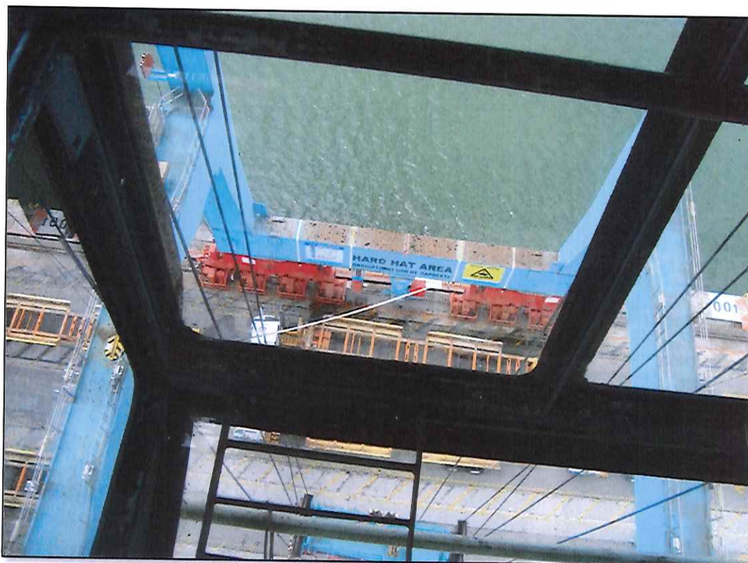
Figura 7. Detalhe do item de check-list #57; vidro da cabine do operador está trincado.
