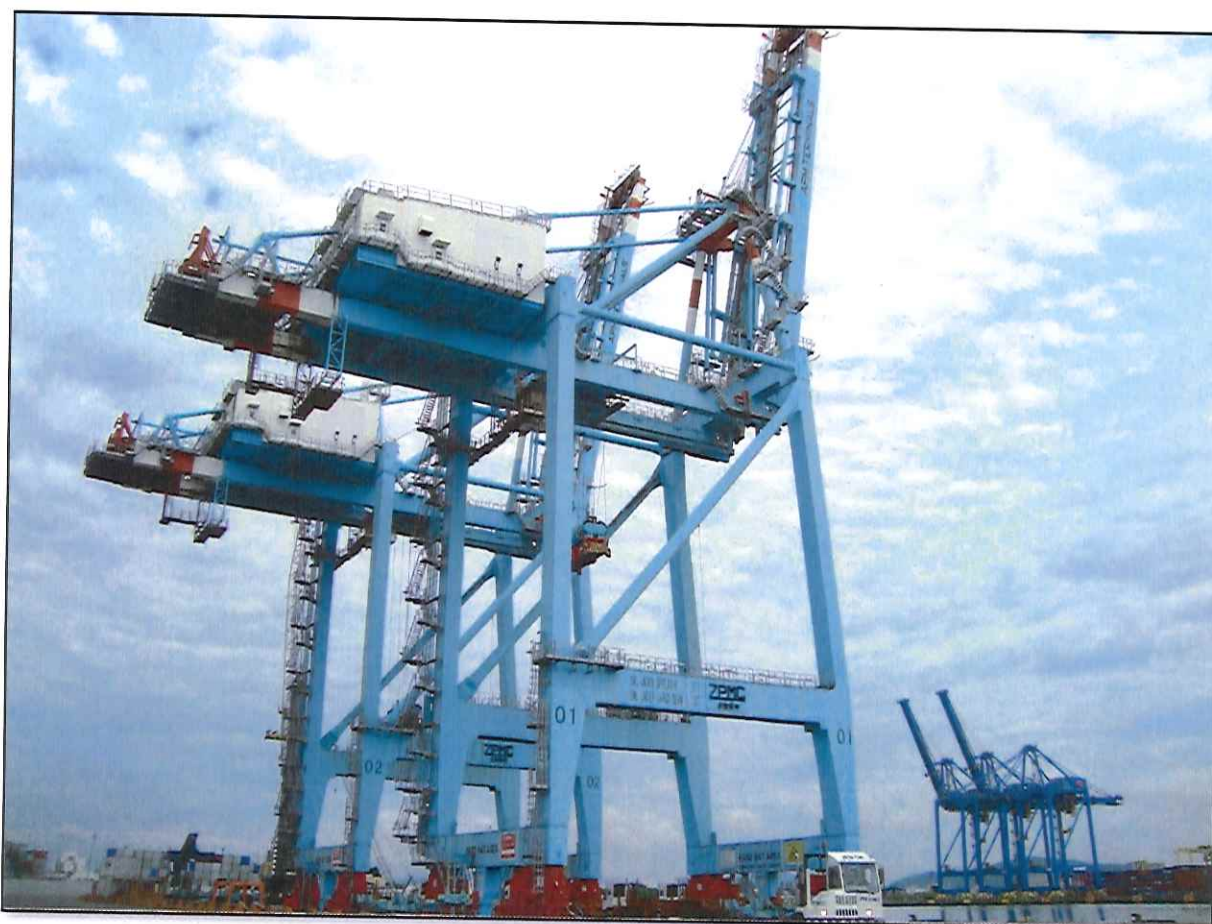
Figura 1. Guindaste de cais (portainer), STS-01.
