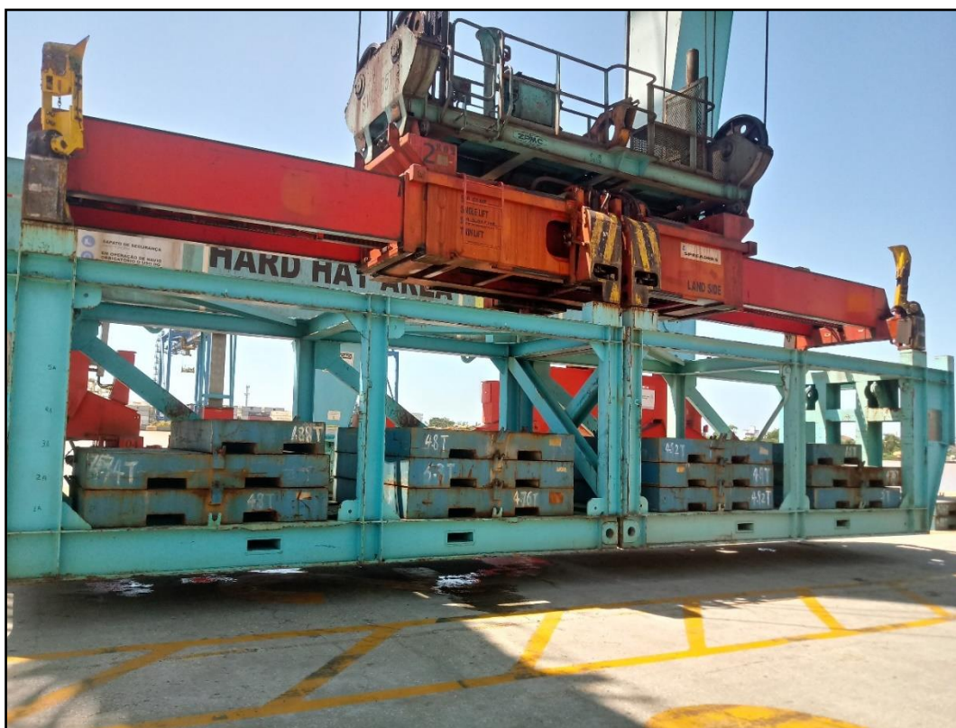
Figura 5. Teste de carga – Twin Lift.
