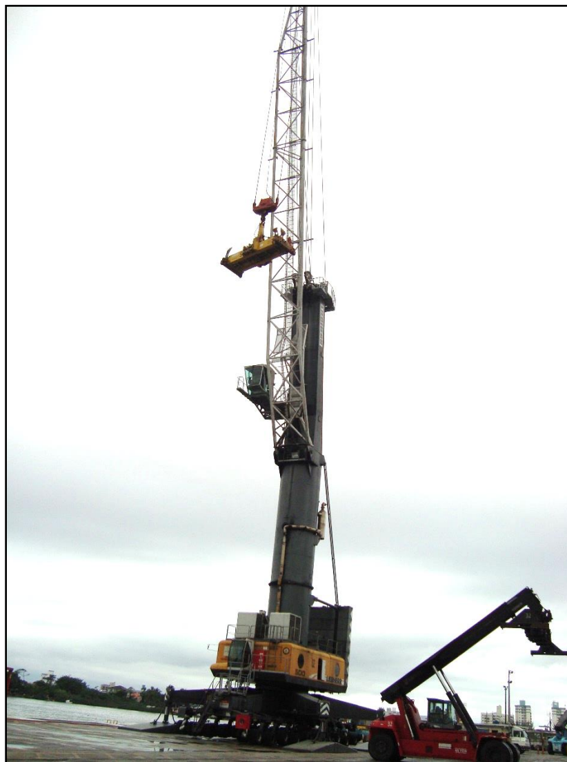
Figura 1. Guindaste de cais (Mobile Harbor Crane), MHC-02.
