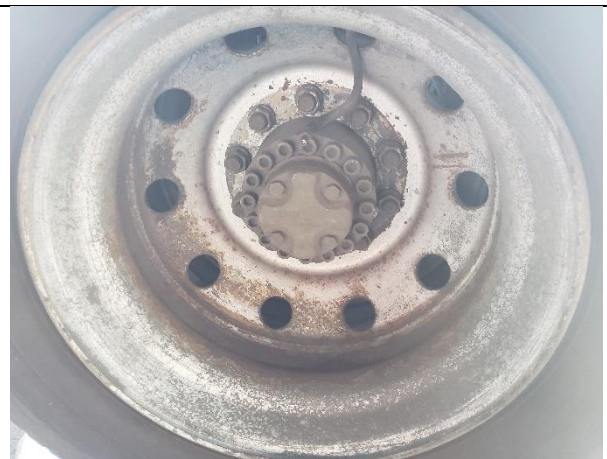
# item 5 – corrosão nas rodas
