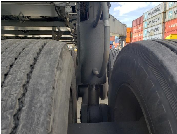
# item 4 – pequeno vazamento no cilindro de compensação dos eixos
