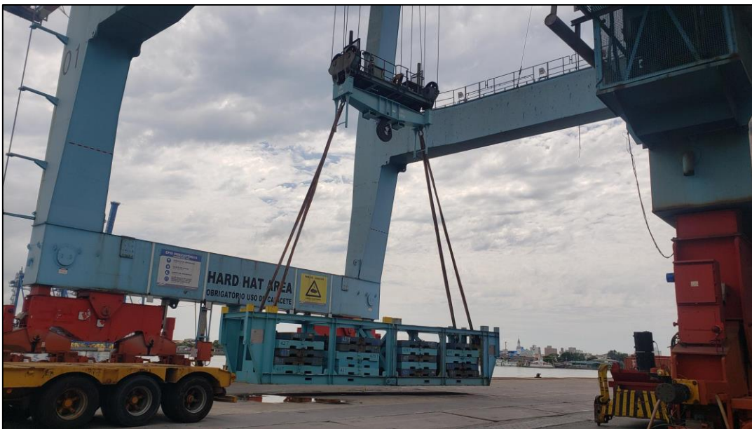
Figura 4. Teste de carga utilizando as manilhas laterais
