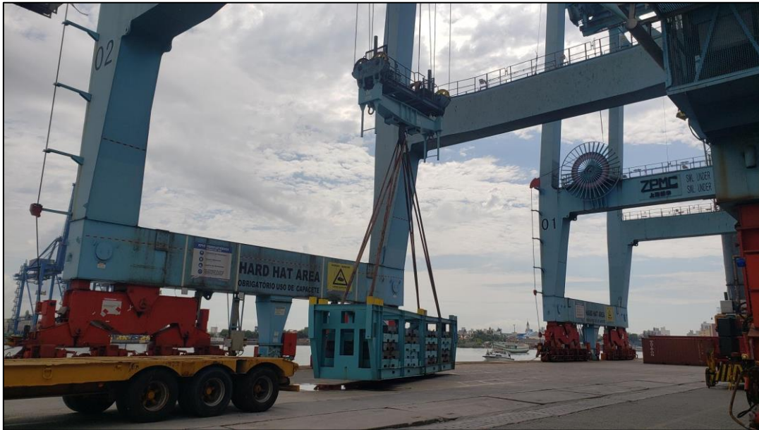
Figura 3. Teste de carga utilizando o gancho
