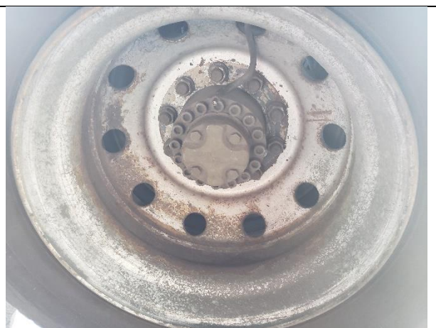
# item 5 – corrosão nas rodas
