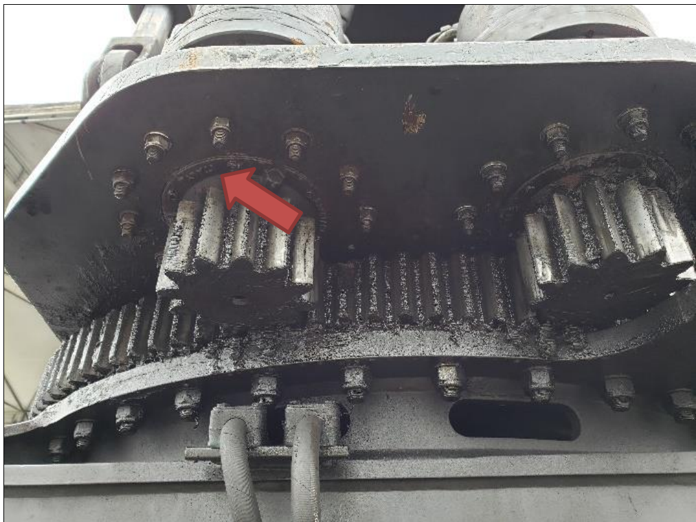
# item 30 – pedaço do dente da coroa de giro quebrado
