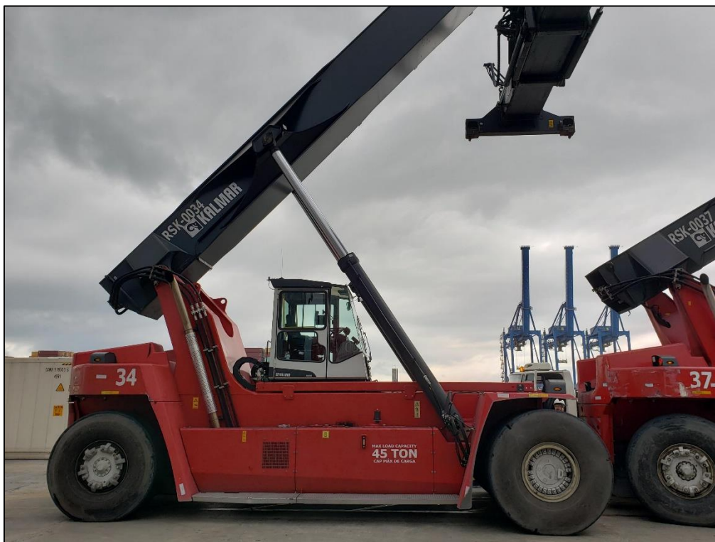
Figura 1. Empilhadeira de grande porte (Reach-Stacker), RSK-0034.
