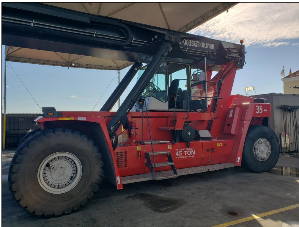
Figura 1. Empilhadeira de grande porte (Reach-Stacker), RSK-0035.
