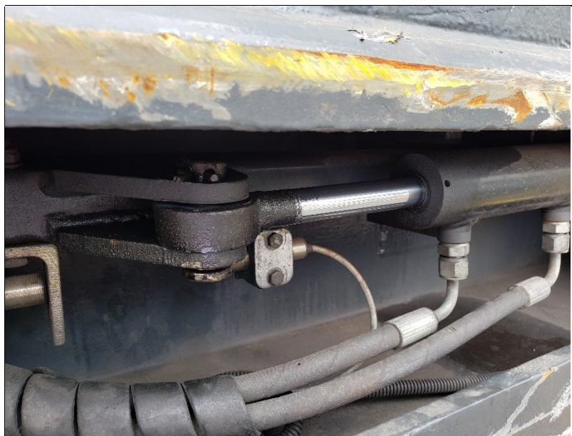
# item 24 – vazamento no cilindro twist lock lado esquerdo
