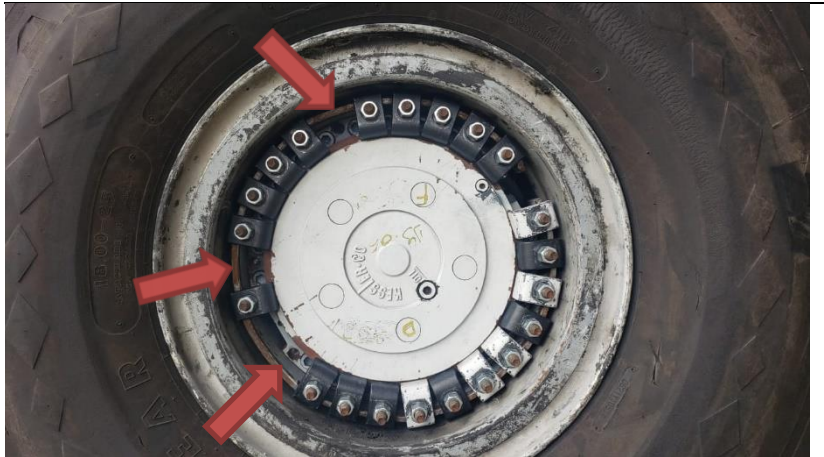
# item 37 – roda dianteira direita faltando 3 castanhas e parafusos de fixação.
