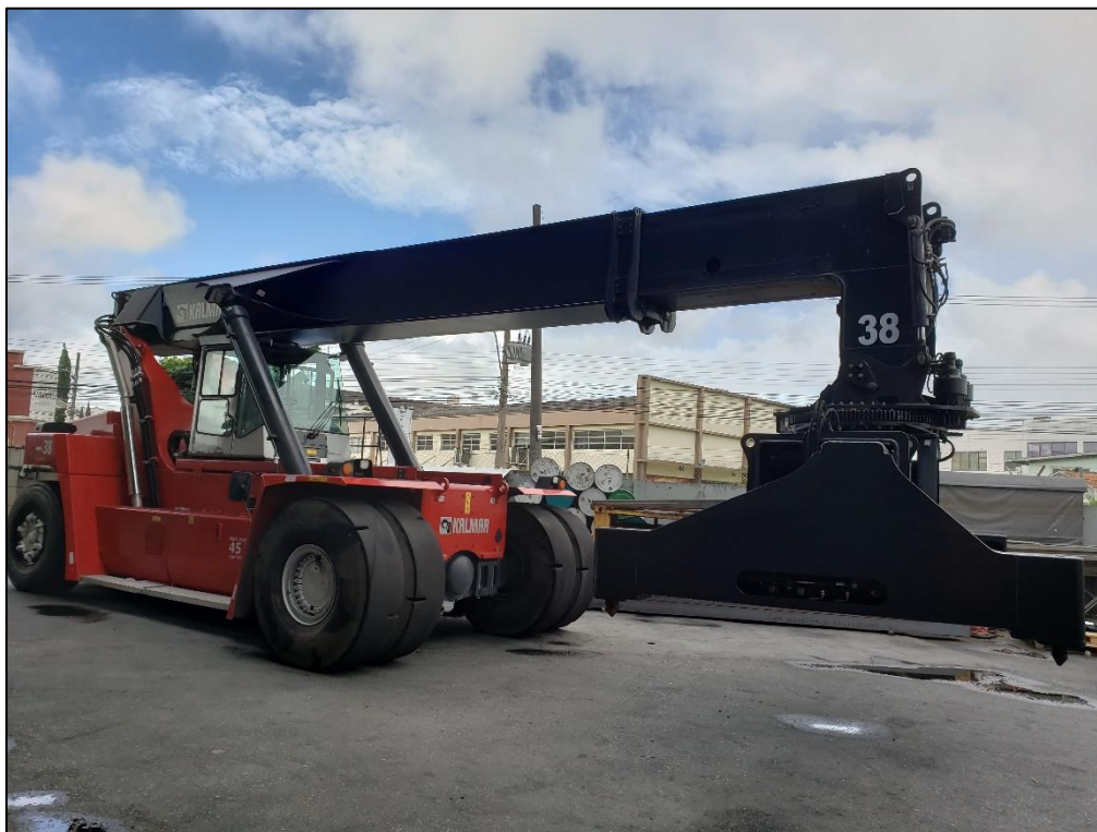
Figura 1. Empilhadeira de grande porte (Reach-Stacker), RSK-0038.
