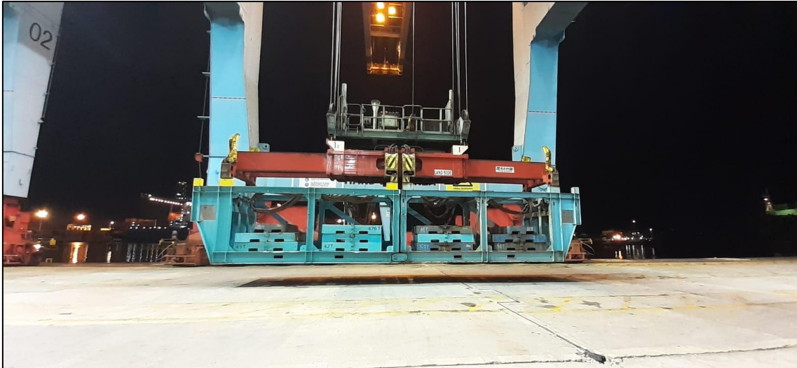
Figura 5. Teste de carga – Twin Lift.
