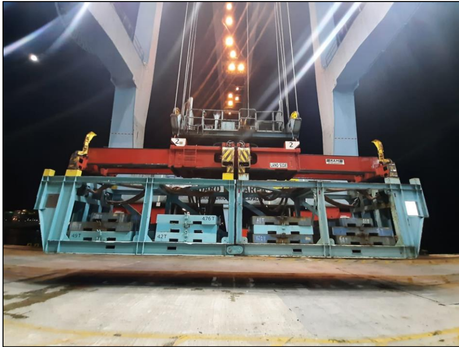
Figura 5. Teste de carga – Twin Lift.
