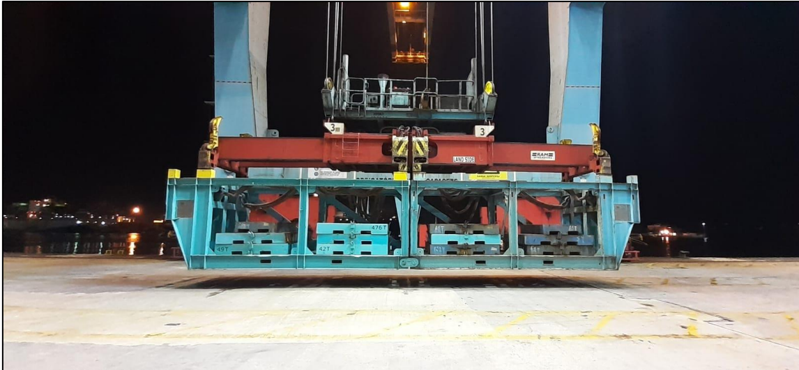
Figura 5. Teste de carga – Twin Lift.
